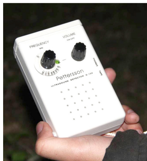
Рис. 4. Простой бэт-детектор, используемый для мониторинга окружающего пространства
