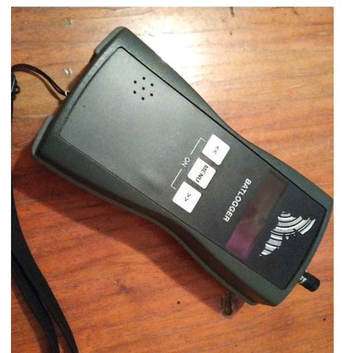
Рис. 5. Бэт-детектор, способный записывать одновременно весь спектр частот
